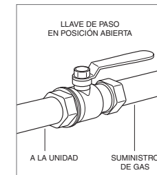
Válvula de cierre del gas
