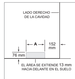
Ubicación del suministro de agua
