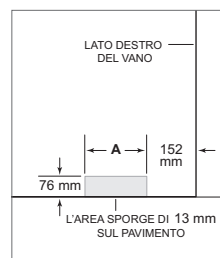
Posizione della condotta dell'acqua
